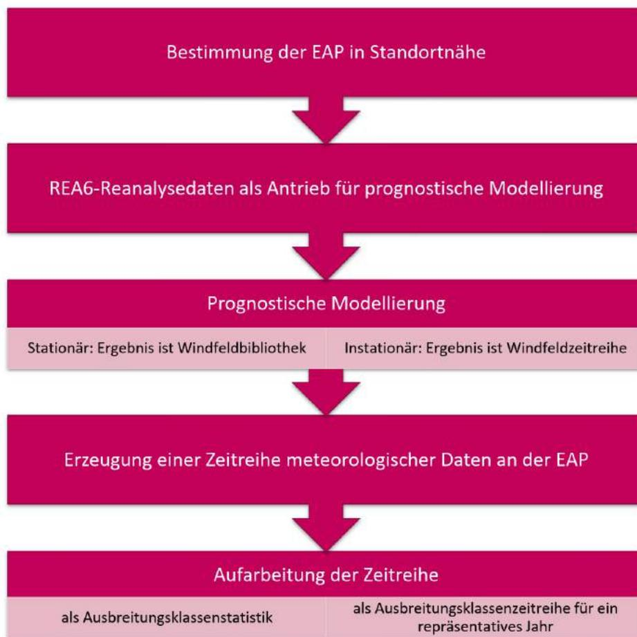
**Abbildung 20: Sequenzieller Ablauf bei der Erzeugung modellierter Daten**
